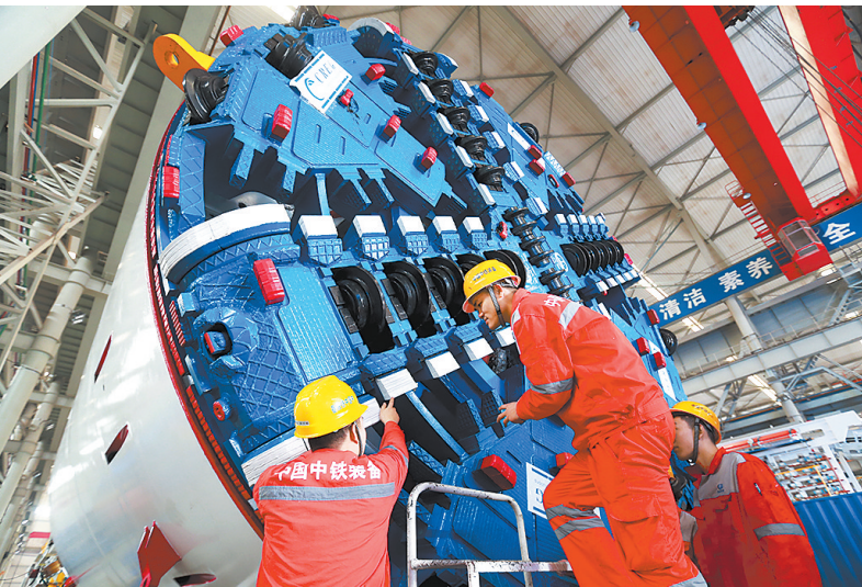
中铁工程装备集团有限公司生产车间内的工人对盾构机进行施工
