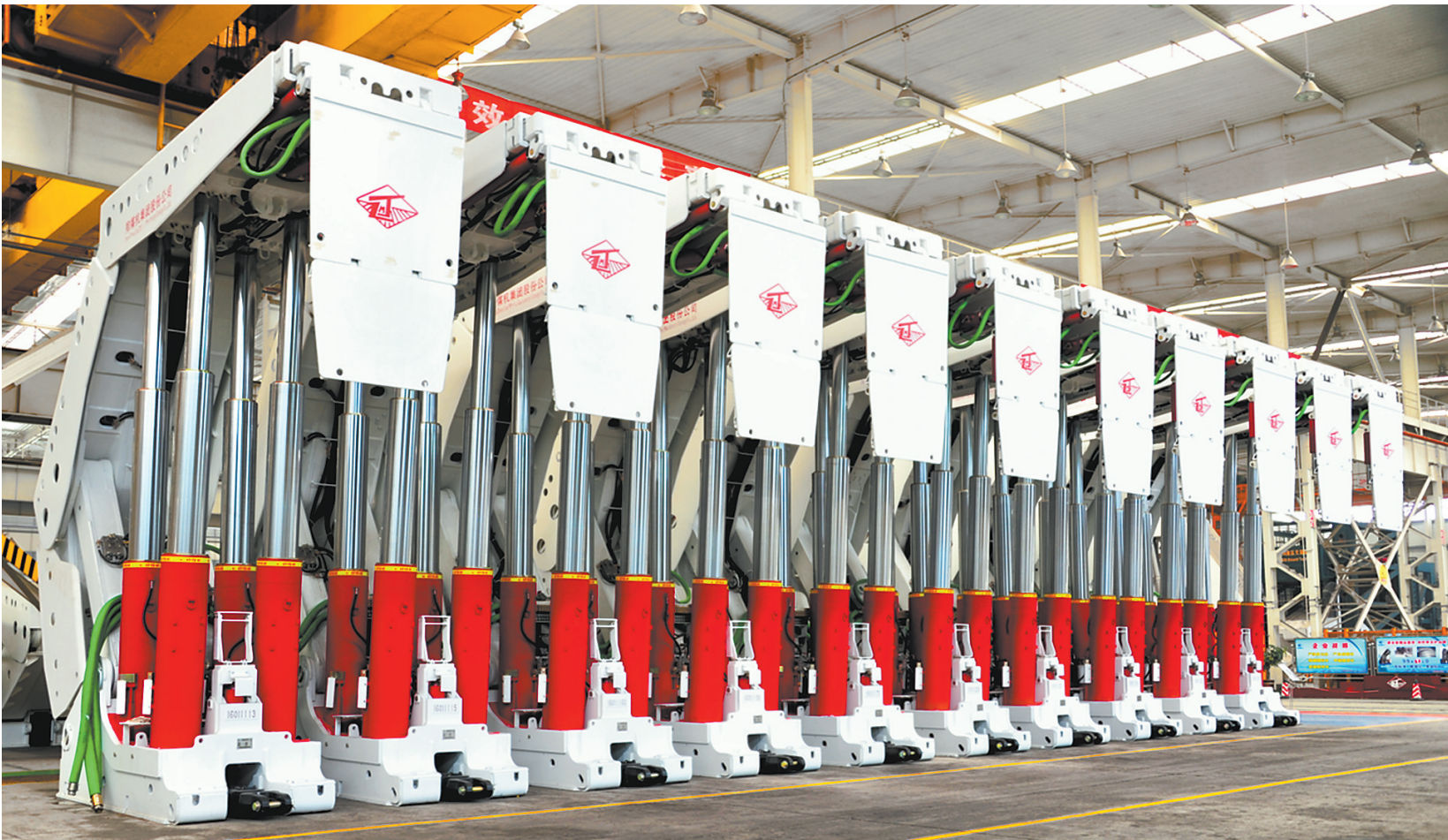
郑州煤矿机械集团股份有限公司研制的8.8米高的液压支架
